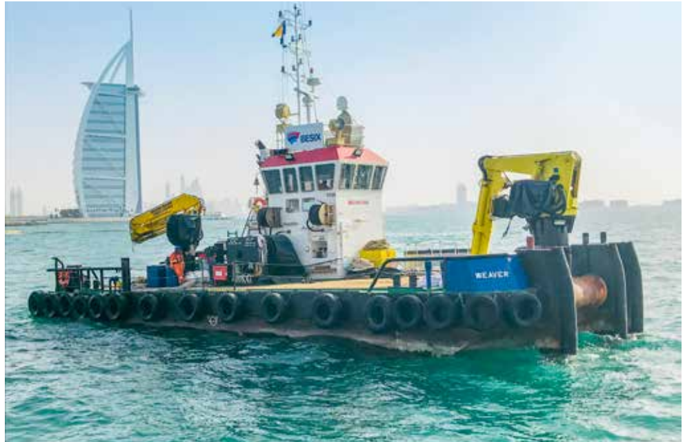
NIEUWE WERKBOOT "WEAVER", met een paaltrek van 24 ton, gebruikt om grote barges te verplaatsen en voor ankerbehandeling
